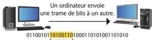
Dans une trame, il y a des mots de plusieurs bits (par exemple ici, un mot de 8 bits : 10100110).
