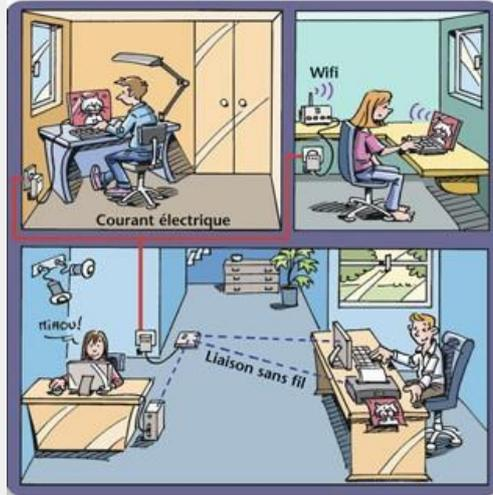
◀ Exemple de réseau utilisé dans une maison. Les liaisons peuvent être faites par des fils dédiés, par des ondes ou par les câbles électriques de la maison.
