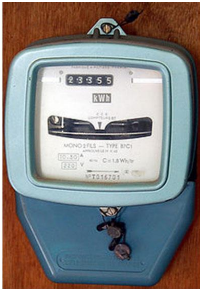
Compteur électromécanique 1 tour de disque électromagnétique = 1,8 Wh
