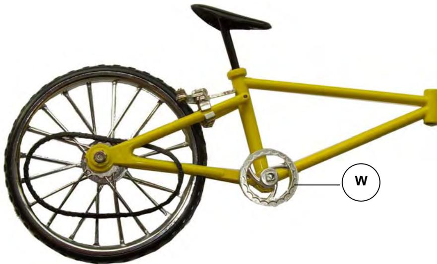
Sur le cadre orienté côté chaîne, glisser le plateau 28 dents (W) à l'emplacement comme indiqué sur la photo ci-dessus.
