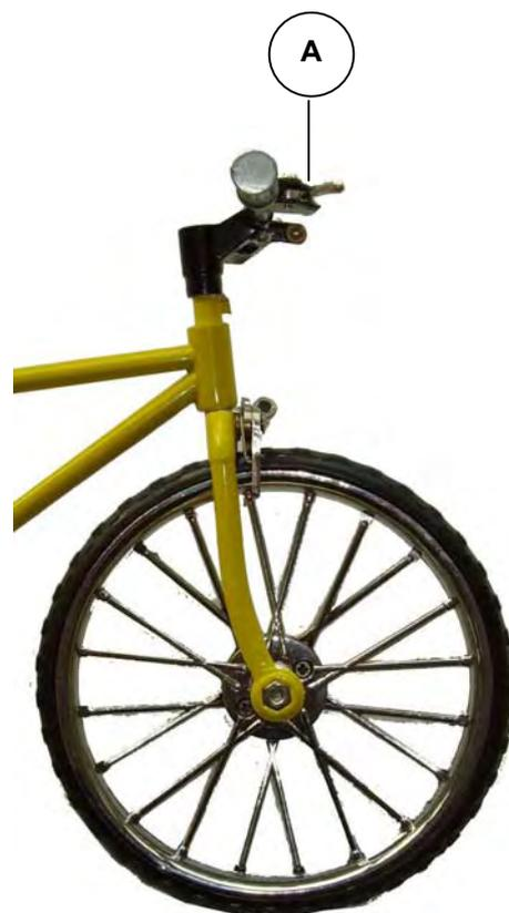
Positionner le guidon (A) sur l'axe de la fourche de la roue avant.
